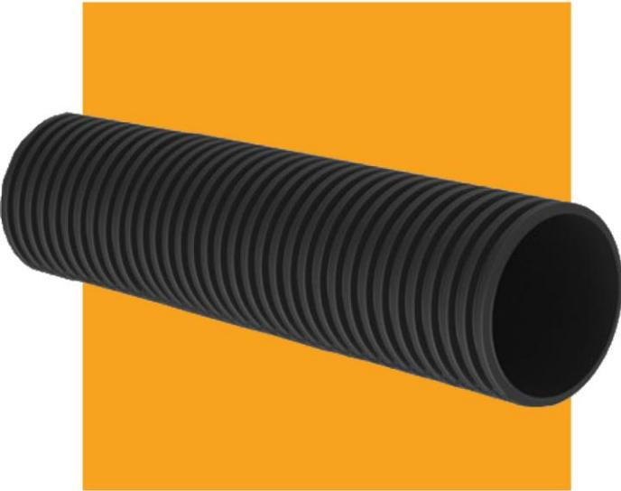
*Tubería fabricada de resina virgen de Polietileno de Alta Densidad (HDPE) según la norma AASHTO M252. El perfil posee un exterior corrugado e interior liso con gran resistencia estructural, flexibilidad para su transporte en rollos y bajo coeficiente de roce que maximiza el flujo.*
