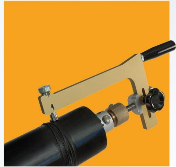
Raspador Orbital para preparar accesorios y tubos antes de la electrofusión.
