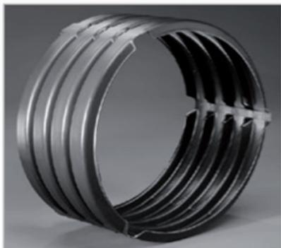
Es un fitting inyectado de HDPE, el que es utilizado para realizar uniones que requieren alta resistencia a la separación y que no necesita exigencias de hermeticidad. Este producto cumple con las normas internacionales ASSJTO M-252 para diámetros de 100 a 250mm (4 a 10") y ASSHTO M-294 para diámetros de 300 a 1500mm (12" 60"). Es sistema es tipo abrazadera utiliza armaras de HDPE, cumpliendo con la norma ATM D-4066.
